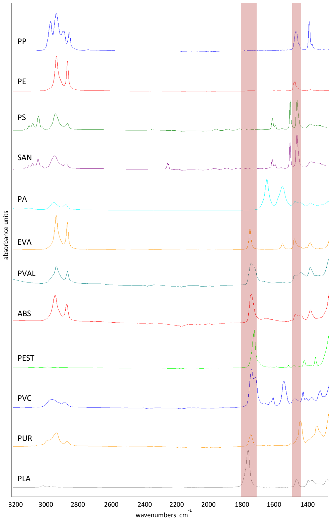
Abbildung 8: Charakteristische Spektren der gängigen Kunststoffe, sowie die angewandten Integrationsbereiche (1480 – 1430 und 1790 – 1700 cm -1 ) zur Partikelanalyse nach Mikro-FTIR Messung
