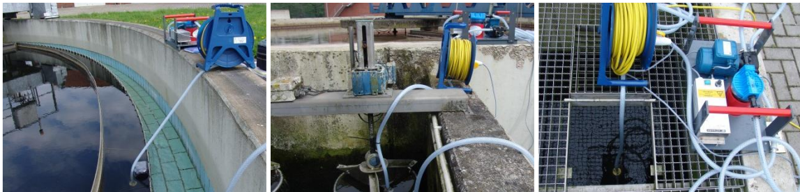
Abbildung 2: Probenahme direkt im Überlauf des Nachklärbeckens (links, KA Burhave) oder im Ablauf des Nachklärbeckens (mitte, KA Holdorf und rechts, KA Scharrel)
